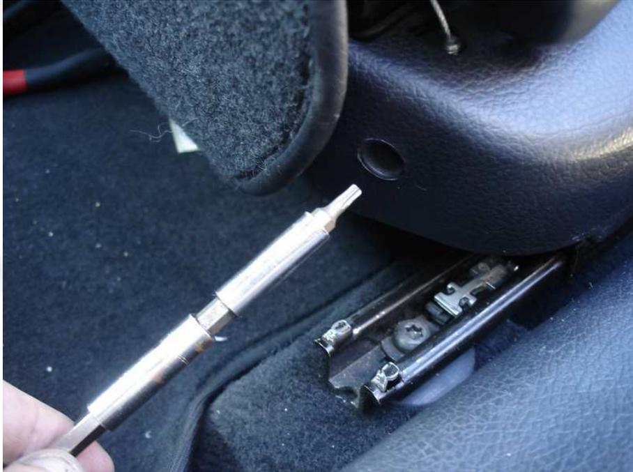
Ensuite, tirer sur le bout de plastique, vers le haut, de façon à désengager les clips de maintien
